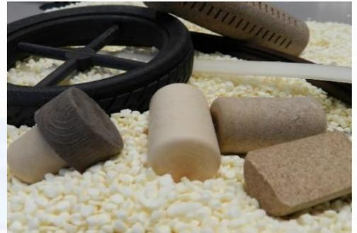
Los principios activos de los compuestos espumantes en general actúan bien físicamente o químicamente. Entre estos últimos los hay exotérmicos y endotérmicos. Los **MASTERFRAN** están **basados tanto en aditivos físicos, químicos endotérmicos o una combinación de ambos**, con concentraciones hasta del 65% para ofrecer diferentes niveles y modos de expansión con el **objetivo de satisfacer todas las solicitudes del mercado**.
